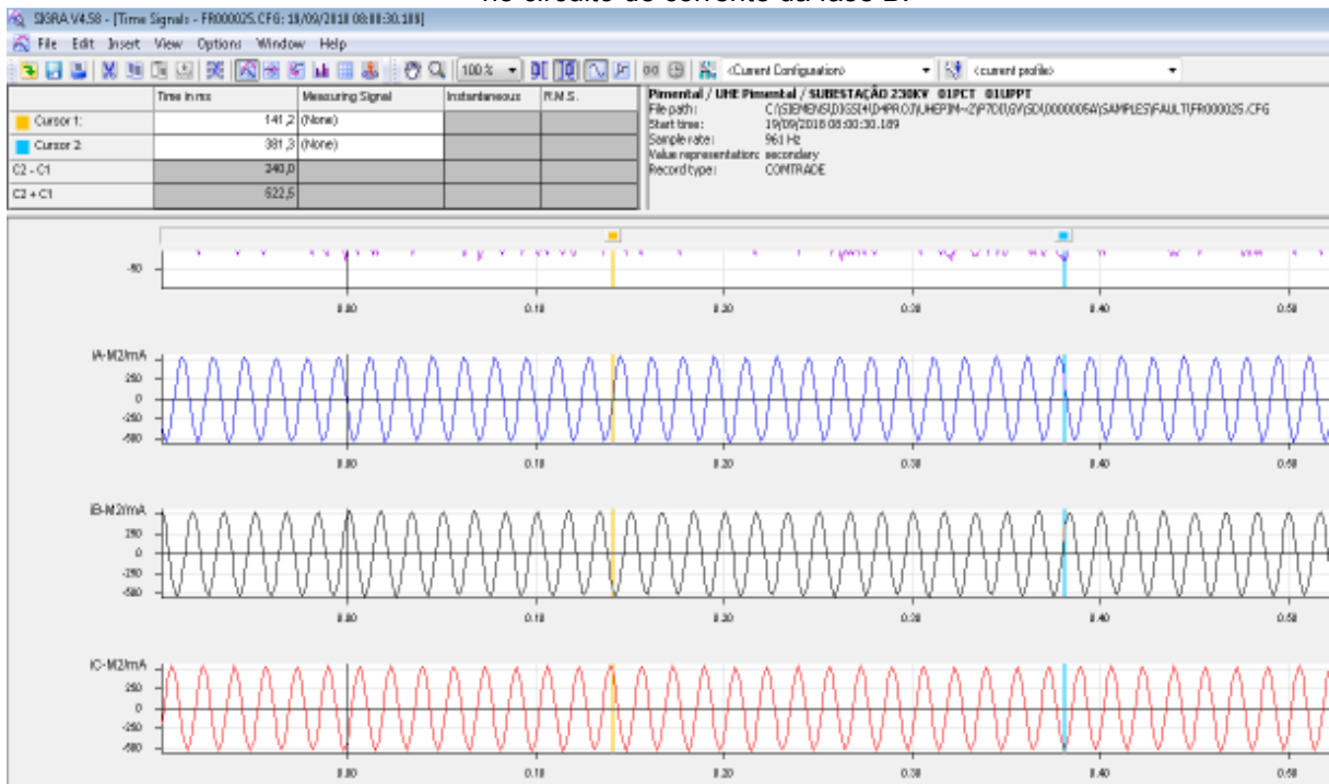
Figura 5.28 – Correntes registradas no lado M2 do transformador PITF6-01 após a manutenção no circuito de corrente da fase B.
