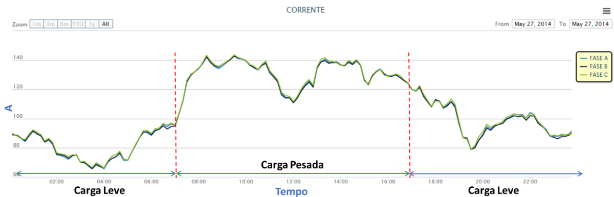
Figura 5-44 – Patamares de carga da universidade. Fonte: Elaborado pelo autor.
