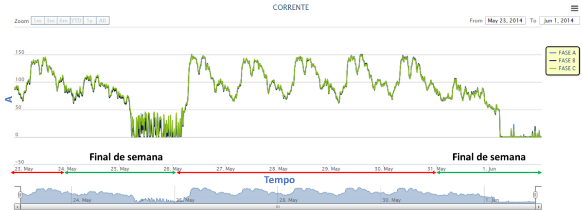
Figura 5-25 – Corrente RMS medida no alimentador DIAL2-16 da SE DI. Fonte: Elaborado pelo autor.
