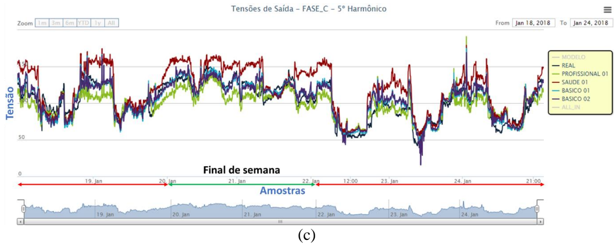
Figura 5-10 – Tensão de saída da RNA de 5º harmônico em cada alimentador para as fases A, B e C na barra de 13,8 kV. Fonte: Elaborado pelo autor.
