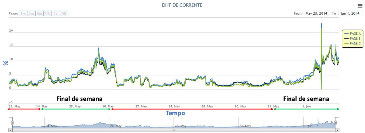
Figura 5-30 – Taxa de distorção harmônica total de corrente medida no transformador DIAL2-17 da SE DI.
