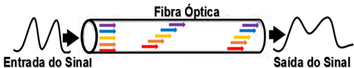
Figura 3.2 - Fenômeno da dispersão em fibra óptica. [Adaptado de 6].
