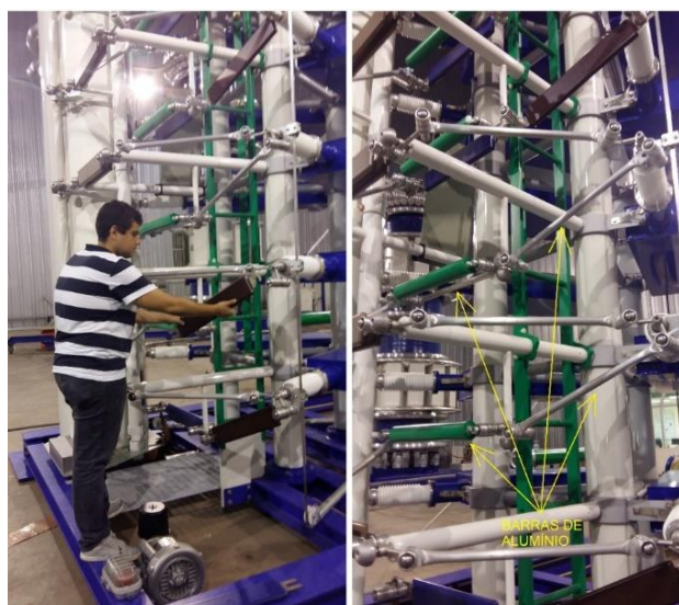
Figura 59 – Disposição dos resistores série e paralelo no circuito de ensaio após modificações
