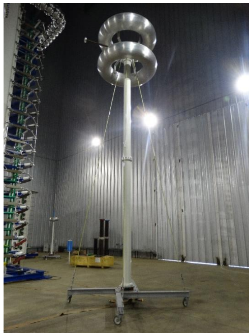
Figura 43 – Divisor de tensão para impulsos de até 2400 kV
