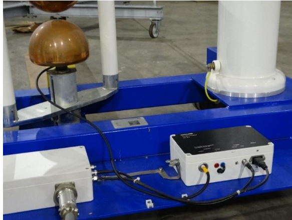
Figura 34 – Sistema Trigger utilizado no Múltiplo chopping gap
