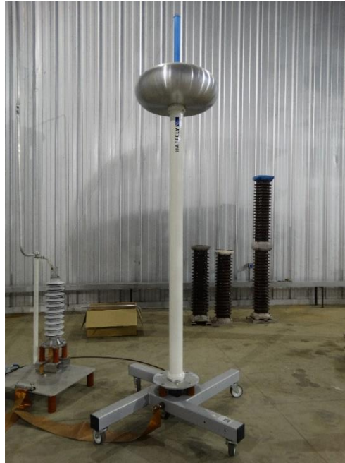
Figura 42 – Divisor de tensão para impulsos de até 1200 kV
