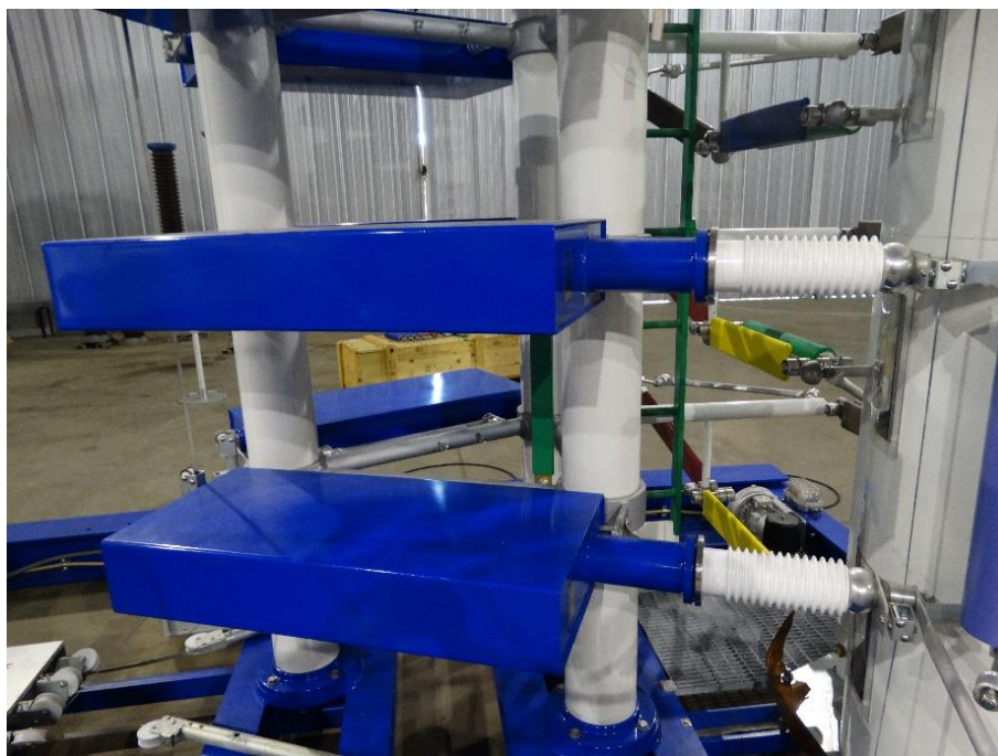
Figura 28 – Capacitores do gerador de impulsos
