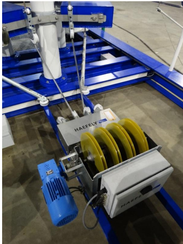
Figura 37 – Sistema de aterramento automatizado por fitas
