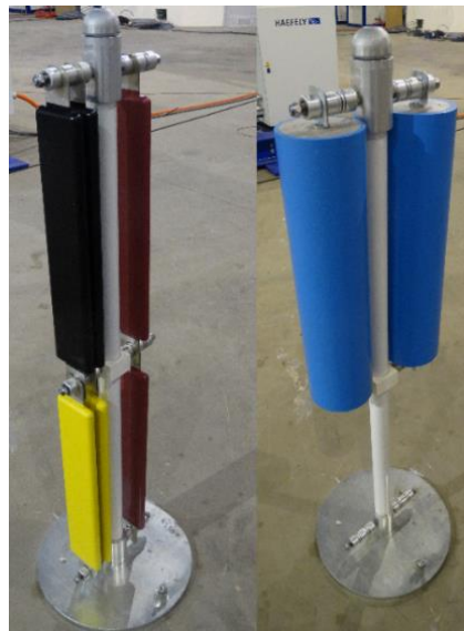
Figura 49 – Elementos do circuito Glaninger do LEAT montados em pedestal próprio
