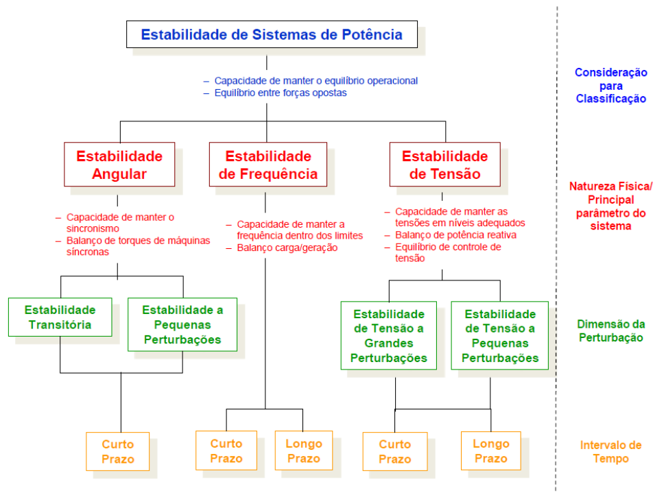
Figura 19 Classificação geral da estabilidade de sistemas de potência [41].
