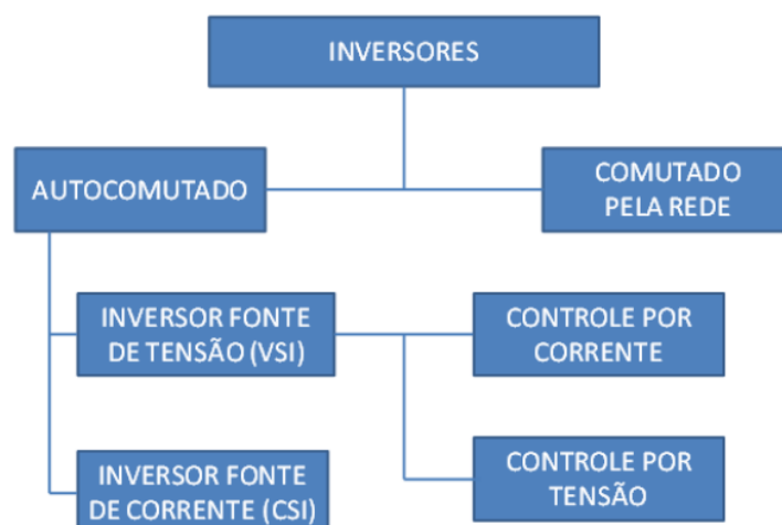
Figura 12 Tipos de inversores classificados de acordo com o princípio de funcionamento [4].
