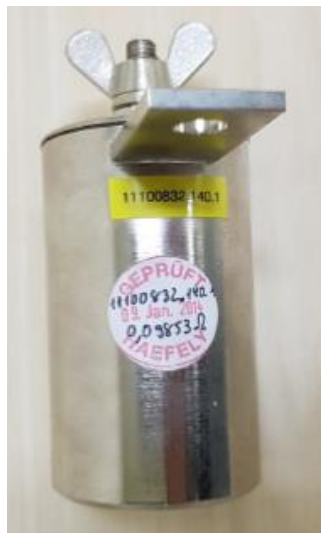
Figura 5.14 - Shunt de medição de 0,1 \Omega
