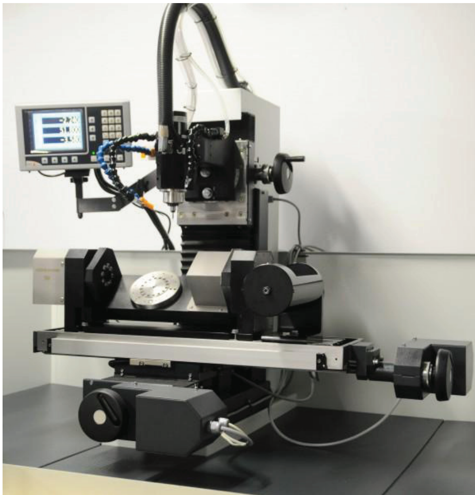
Figura 2.1 - Planta eletromecânica de uma máquina de com três graus de liberdade. (Fonte: MDA Precision)
