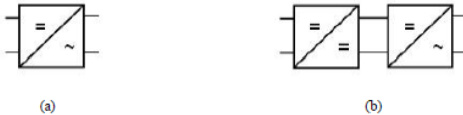
Figura 5. a) Inversor de um estágio, b) Inversor de dois estágios (Adaptado de [11])
